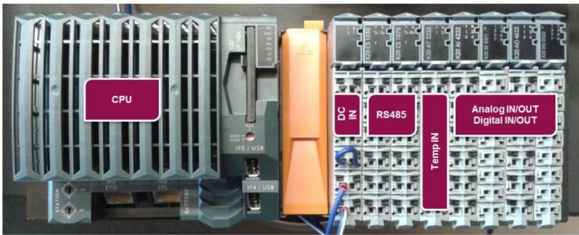
Abbildung 23: Hardware-Aufbau des juwi EMS
